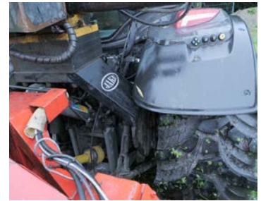
Der Jake-Rahmen wurde ab Werk geliefert. Auf diesen konnte Otterbach anschließend seinen alten Kran aufbauen.
