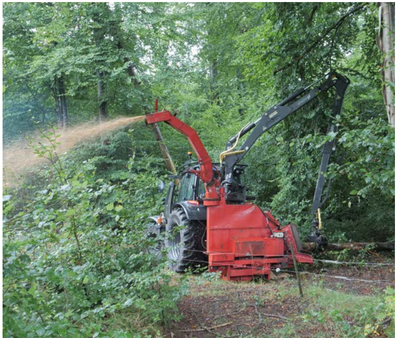
Ein Anbauhacksler, der zur Handbeschickung gedacht war, kann nun bequem von der Traktorkabine aus beschickt werden.
